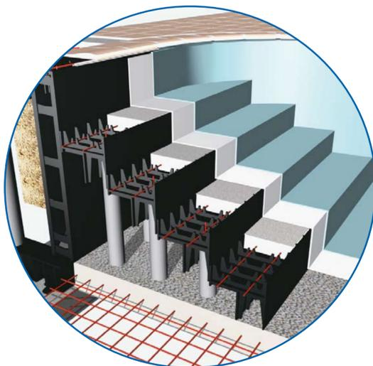
Il nostro processo integra diverse forme di scale (romana, diritta, a trapezio, obliqua,...) disponibili in misure diverse e direttamente gettate insieme alla piscina. Sostenuti da blocchi riempiti di calcestruzzo, i gradini della scala sono armati e solidamente ancorati alla struttura. In questo modo l'opera è costituita da un insieme monoblocco omogeneo e indeformabile. La scala verrà rivestita con un liner garantendo un'omogeneità perfetta dei colori della piscina.
