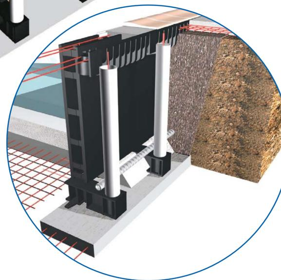
Il liner è solidamente mantenuto in una estrusione prevista appositamente, la quale è perfettamente ancorata alla struttura in cemento armato. Il liner non rischia di staccarsi.
